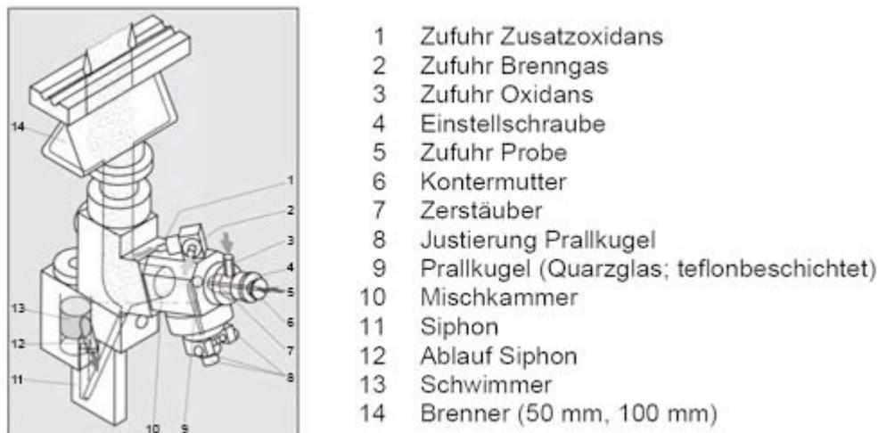
Bild 2-13: Schematische Darstellung Mischkammer-Zerstäuber-System
