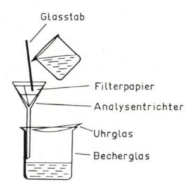
Man verwendet zum Filtrieren Filterpapiere, welche unterschiedliche Porengrößen besitzen können. Grobkristalline Niederschläge werden mit weitporigem, "weichem" Papier; feinkristalline Niederschläge mit engporigem "hartem" Papier abfiltriert.
